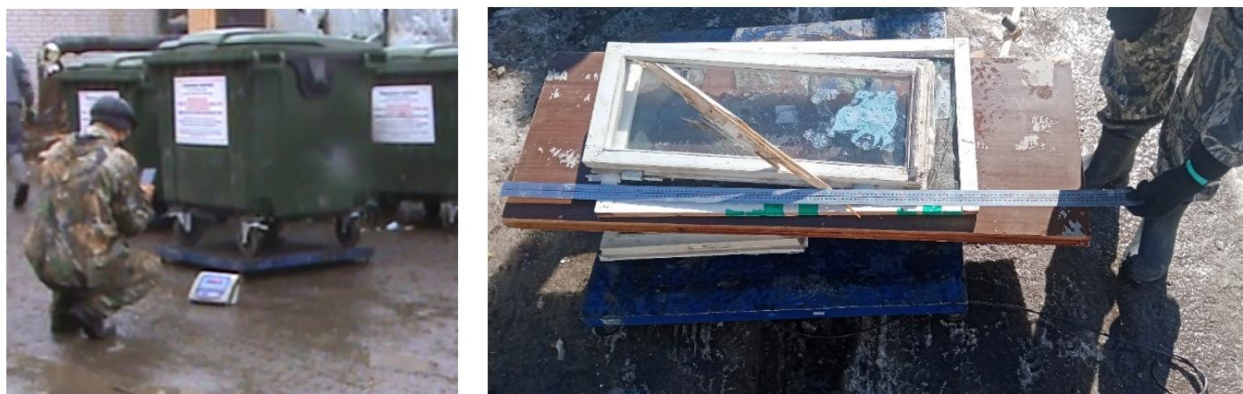
Рис. 2. Взвешивание контейнеров на колесной основе и крупногабаритных отходов с помощью платформенных весов
