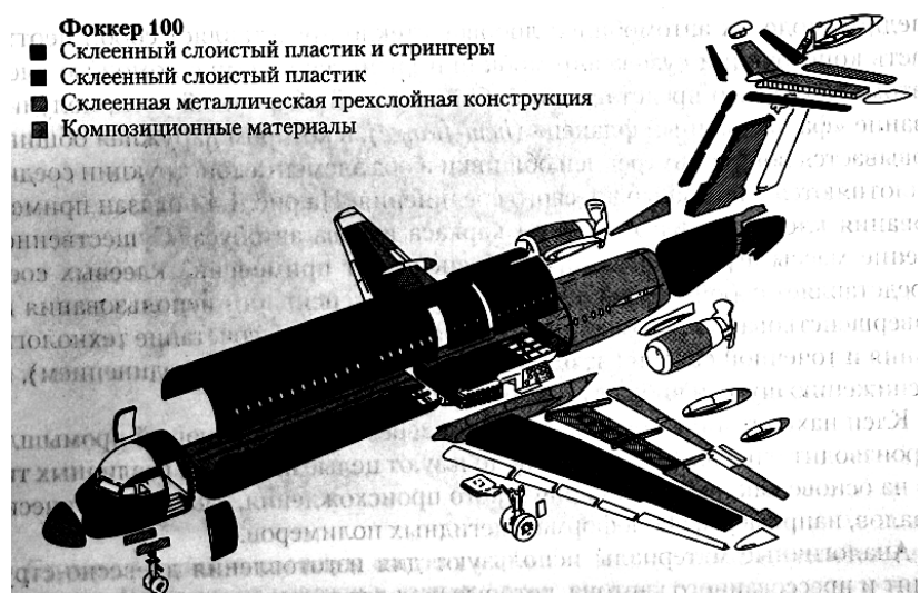
Рис. 1. Схема элементов самолета Фоккер F-100 (Fokker F-100), в которых использованы клеевые соединения
