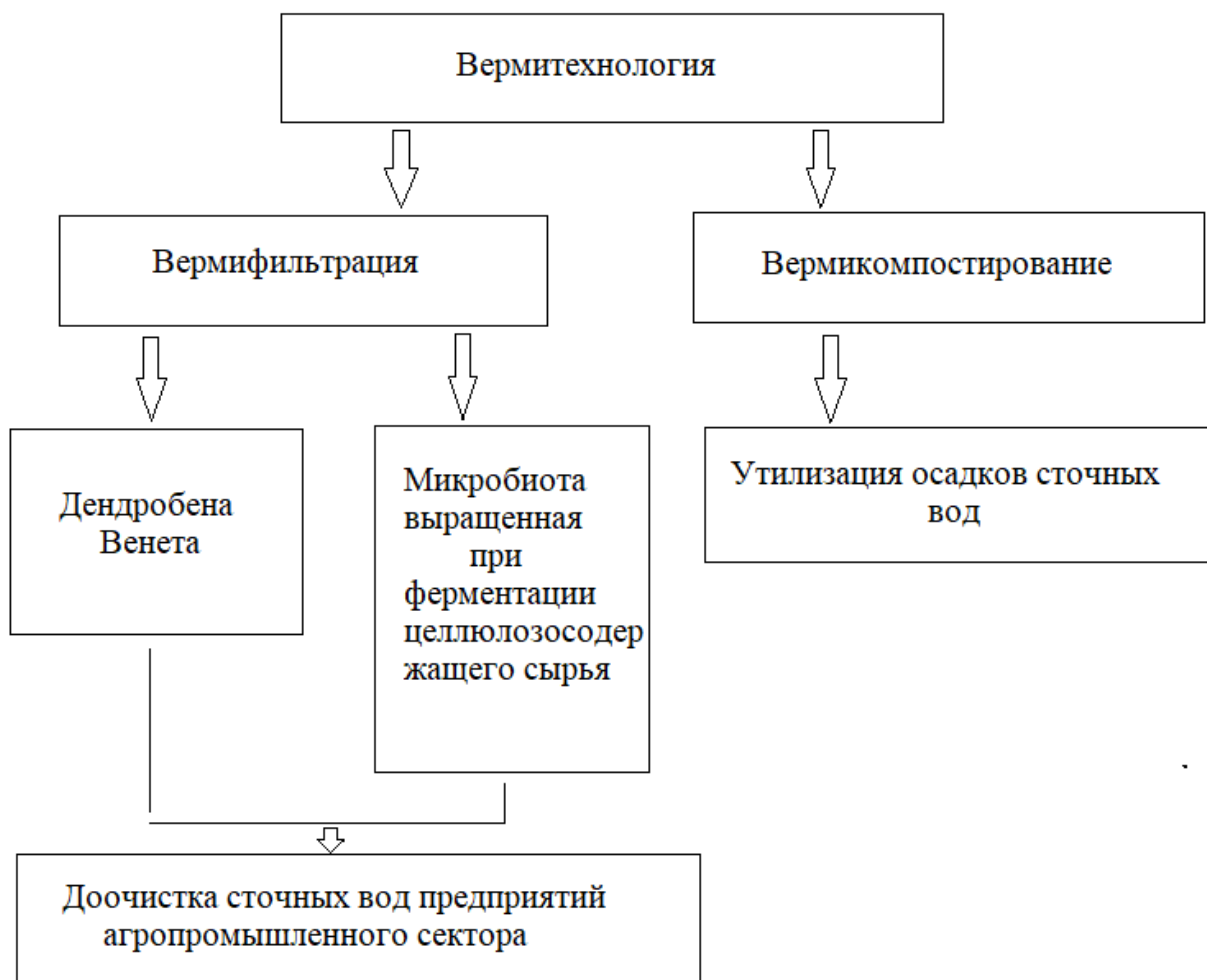
Рис. 2. Схема вермибиотехнологии при очистке сточных вод и утилизации их осадков
